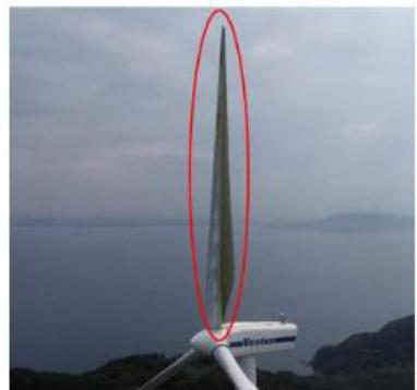
7号風車：ブレード1枚破損
