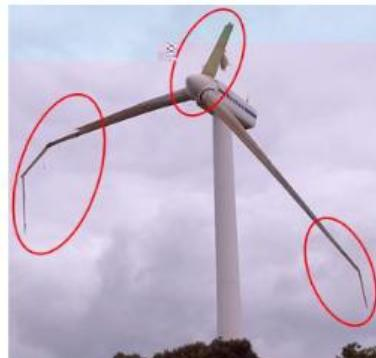
8号風車：ブレード3枚破損
