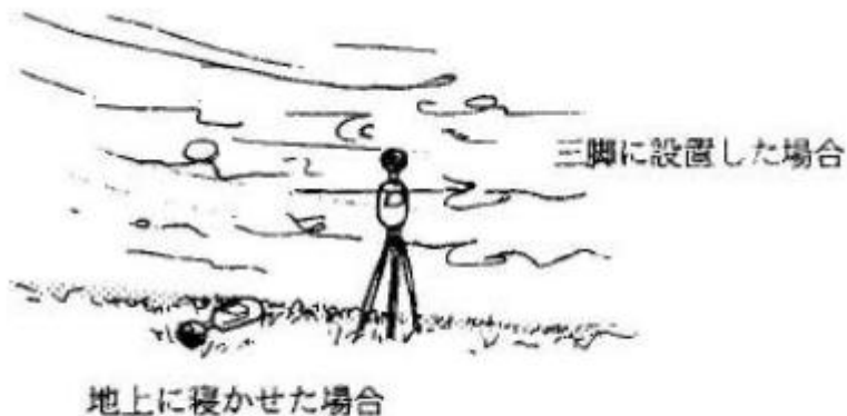
図-5.2.1 風がある場合のマイクロホン設置方法の概略図
