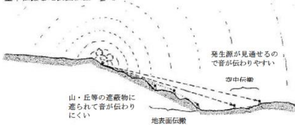
図-5.1.5 遮蔽物、反射物の有無による音の伝わり方の違い
